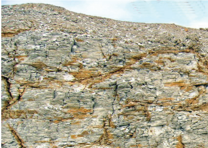
شكل رقم (٣). قطاع رأسي بأحد الحفر لأخذ العينات ( عمق أخذ العينات تراوح من ٢ إلى ٣ متر من سطح الأرض).
